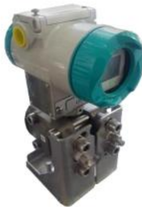
Figura 38: Transmissor Diferencial de Pressão (Nível)
