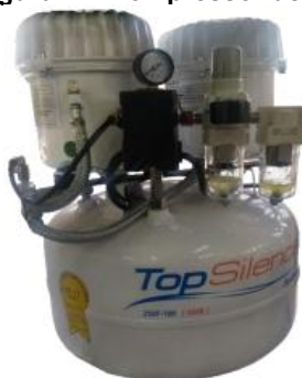
Figura 11: Compressor de Ar
