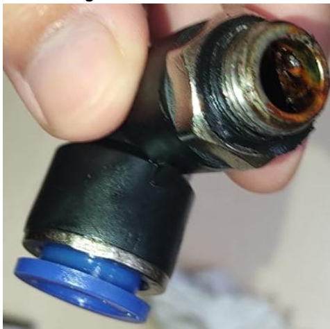
Figura 77: Ferrugem e Corrosão na Tomada de Nível
