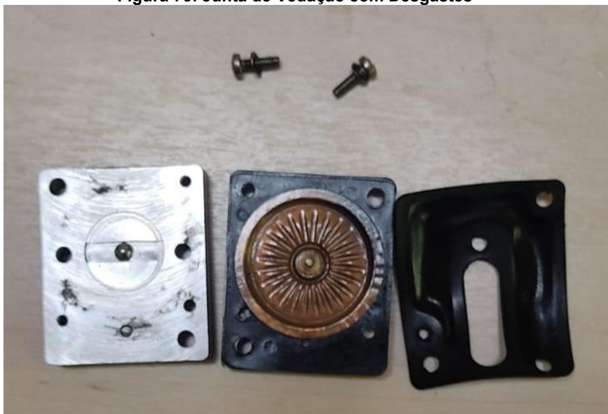
Figura 75: Junta de Vedação com Desgastes
