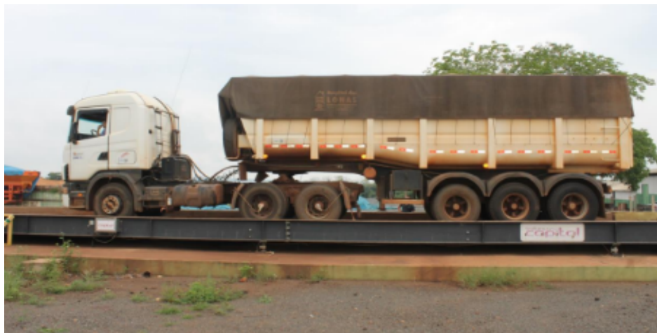
Figura 6.3 - Modelo de veículo de prova de carga e o veículo utilizado durante o teste.
