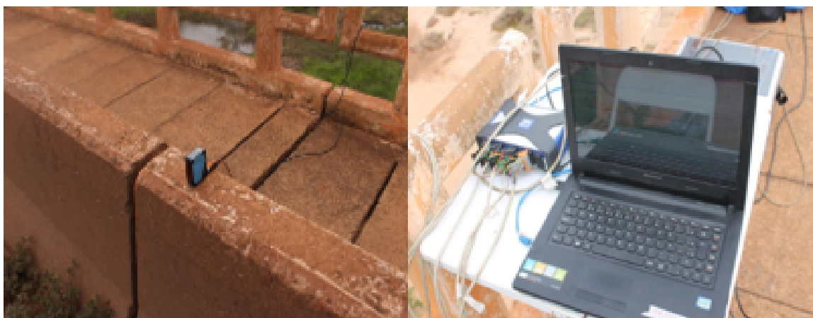
Figura 6.4 - À esquerda dispositivo de detecção à laser e à direita a aquisição de dados pelo computador.
