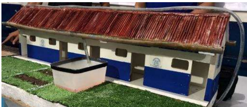
Figura 32 - Representação do sistema de captação e armazenamento
