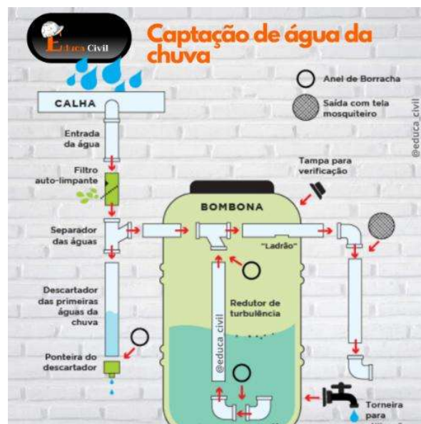
Figura 27 - Esquema de funcionamento mini cisterna
