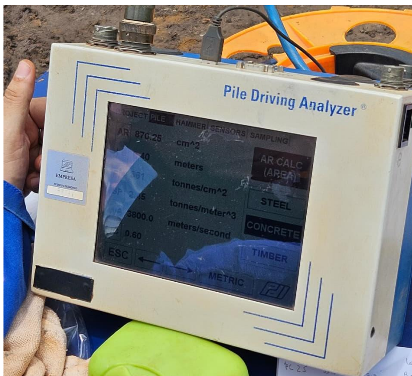
Figura 19 – Inserção das características da estaca ensaiada no PDA.
