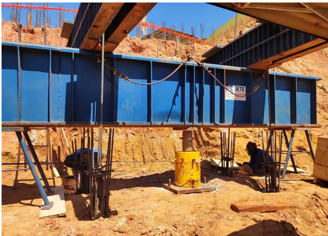
Figura 11 – Sistema de reação para ensaio PCE.
