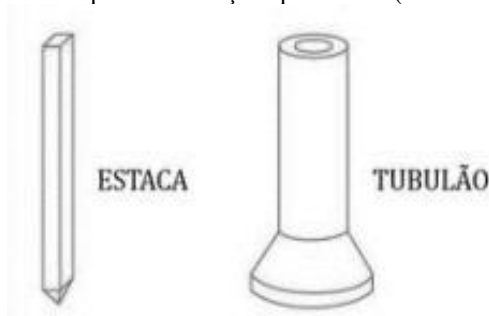
Figura 1: Tipos de fundações profundas (estaca e tubulão)
