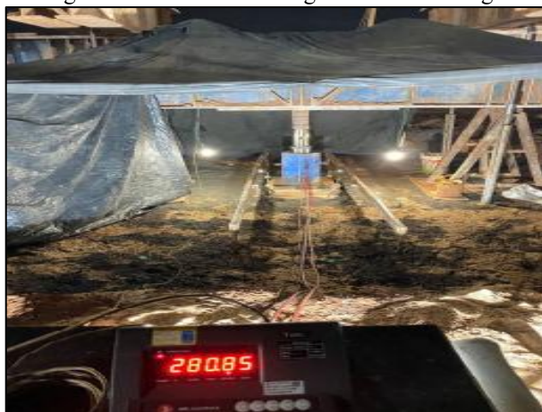
Figura 32: Indicador de carga da célula de carga.
