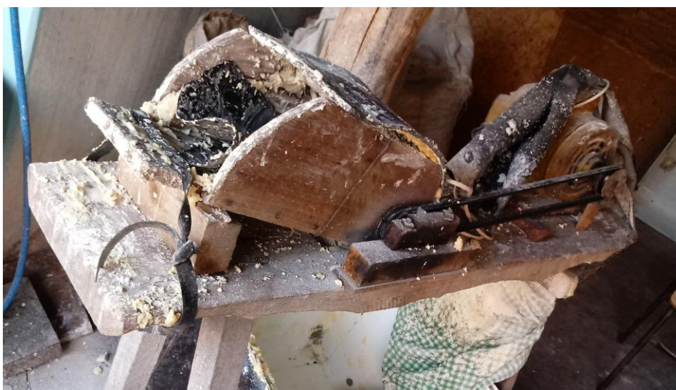
Figura 2 – Ralador de mandioca elétrico simples, utilizado pela artesã entrevistada
