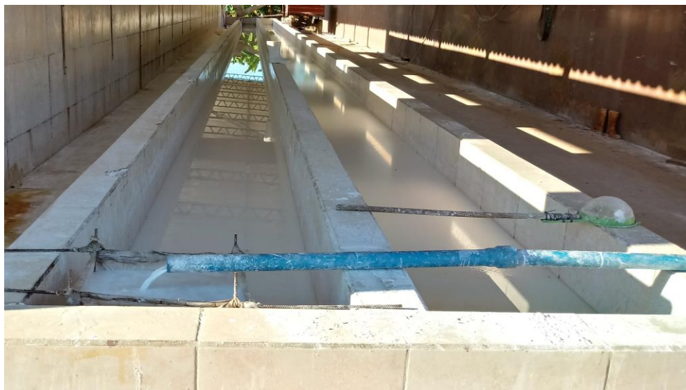
Figura 5 - Tanque de decantação da fécula no processo industrial de fabricação do polvilho
