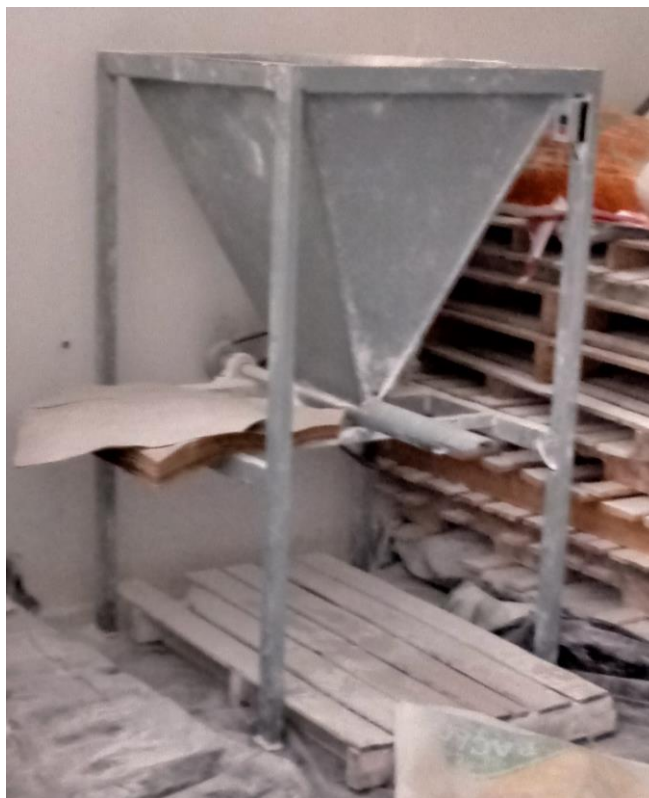
Figura 7 - Máquina utilizada para ensacar polvilho na produção industrial
