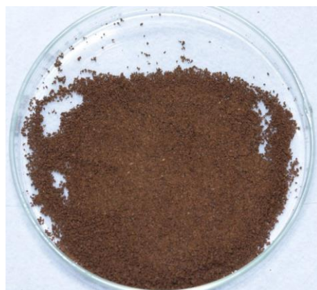
Figura 8. Amostra 1 - Placa de Petri (0% de carvão). Fonte: Autoria Própria.
