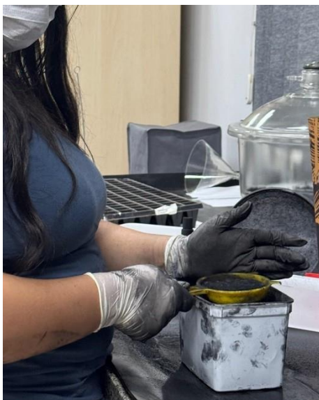
Figura 5: Processo peneiração do carvão. Fonte: Autoria Própria.
