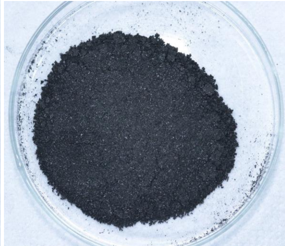
Figura 12. Amostra 51 – Placa de Petri (50% de carvão). Fonte: Autoria Própria.
