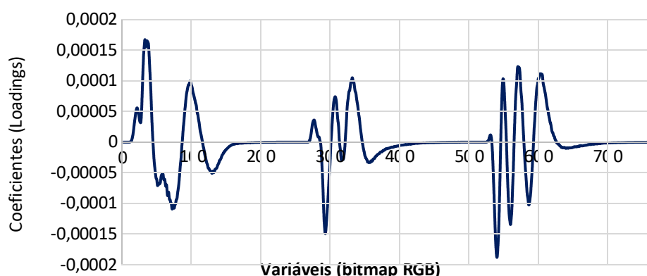
Figura 29. Vetor de regressão (coeficientes) com base na matriz de loadings do modelo PCR, usando 15 componentes principais, obtidos das imagens das amostras no Copinho de Café.
