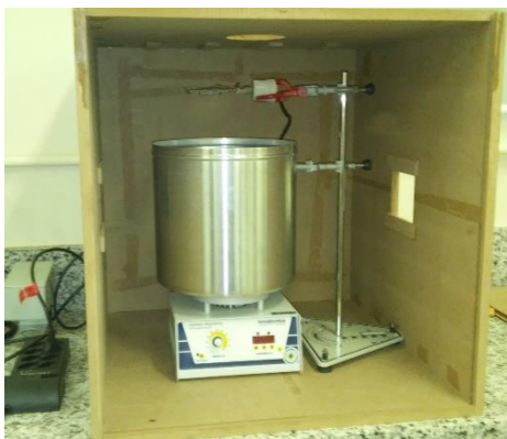
Figura 3 – Fotoreator com utilização de radiação UV artificial, usado nos experimentos de irradiação das soluções do corante V.40.
