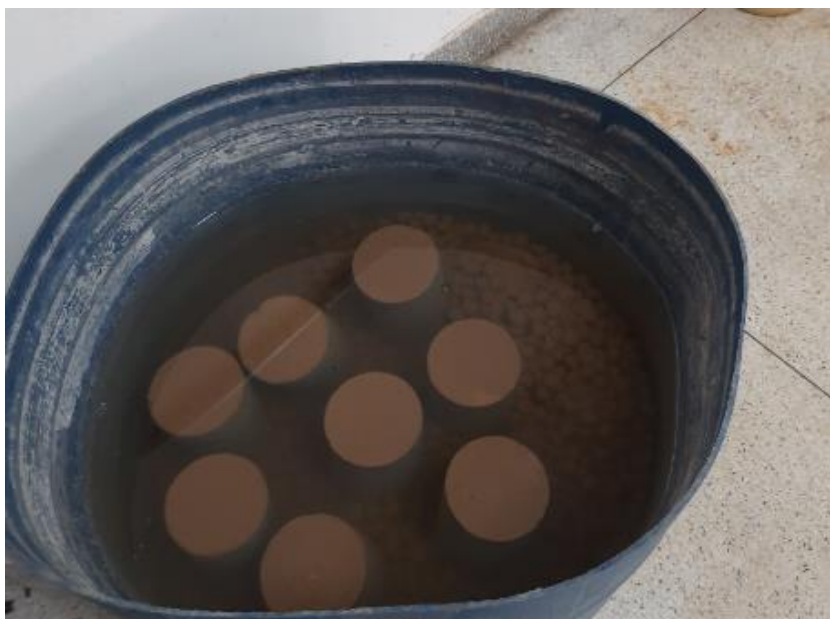
Figura 26 – Corpos de prova moldados (cura úmida)
