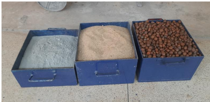
Figura 24 – Materiais usados na produção do concreto
