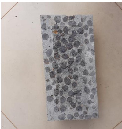
Figura 27 – Disposição dos agregados
