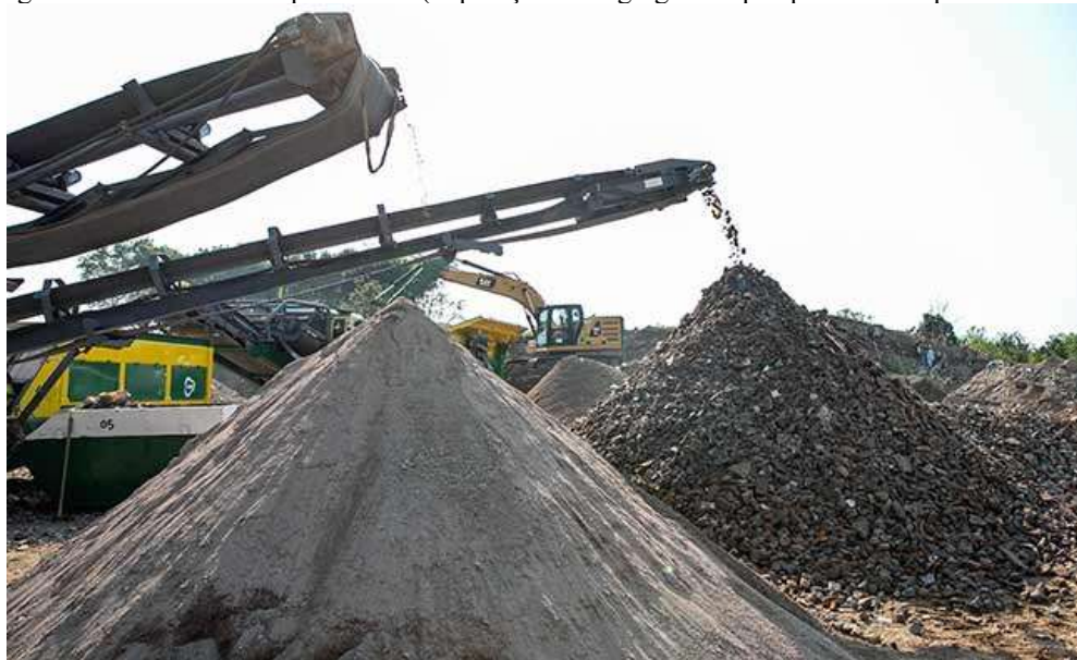
Figura 11 – Esteiras transportadoras (Separação dos agregados após processo de peneiramento)
