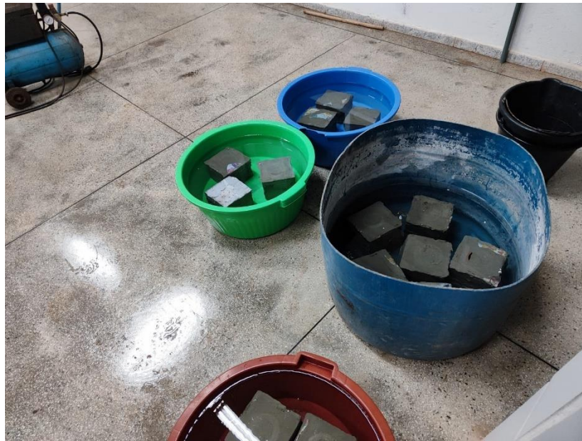
Figura 3.13 - Corpos de prova imersos em água
