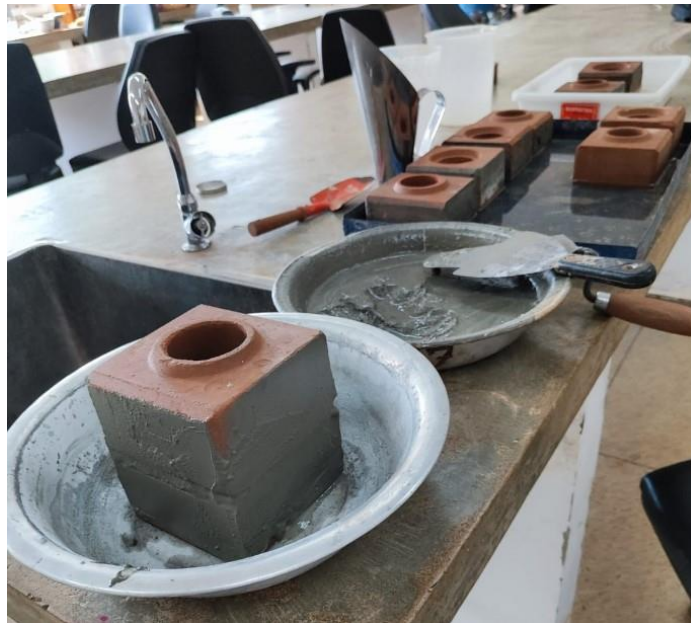
Figura 3.10 - Preparação dos corpos de prova
