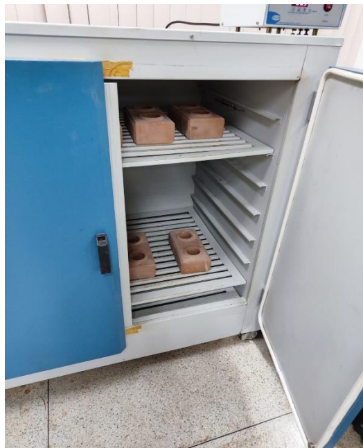
Figura 3.15 - Blocos de solo-cimento em secagem na estufa
