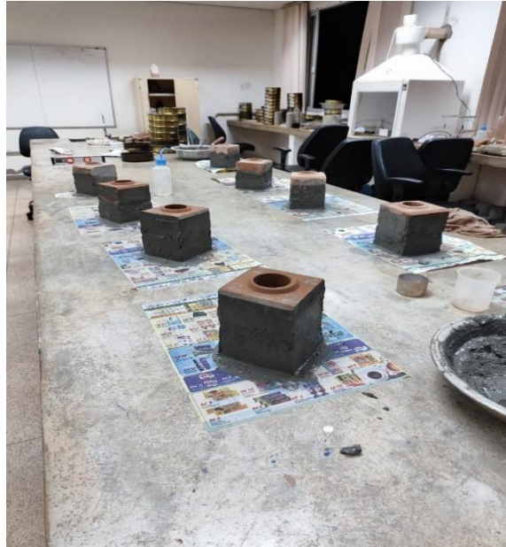
Figura 3.11 - Capeamento dos corpos de prova
