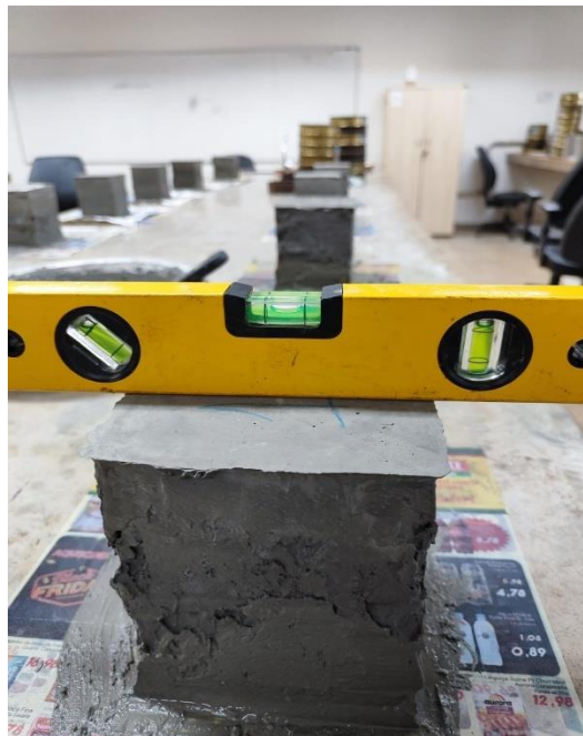
Figura 3.12 - Regularização das faces dos corpos de prova
