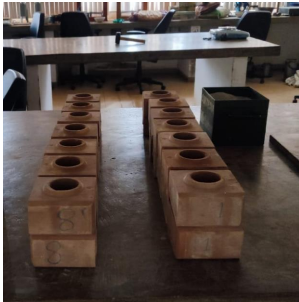
Figura 3.8 - Blocos de solo-cimento cortados
