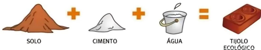
Figura 2.1 - Componentes da mistura solo-cimento
