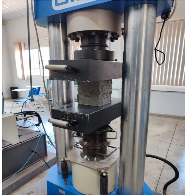
Figura 3.14 - Posicionamento do corpo de prova na prensa para ensaio de resistência à compressão simples
