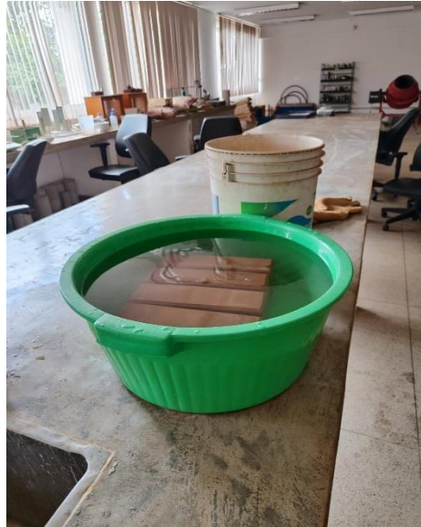
Figura 3.16 - Blocos de solo-cimento imersos em água para o ensaio de absorção
