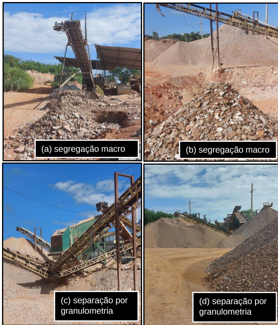
Figura 14 – Segregação macro (a) (b) e separação dos agregados por granulometria (c) (d)
