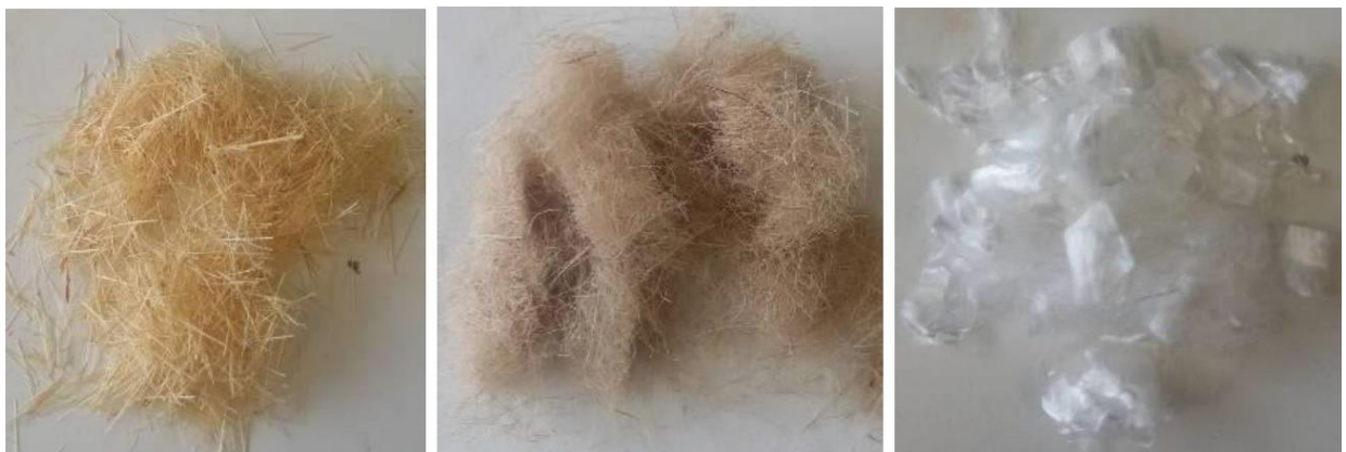
Figura 5 – Fibras Naturais. Fibras utilizadas na pesquisa (sisal, rami e polipropileno).
