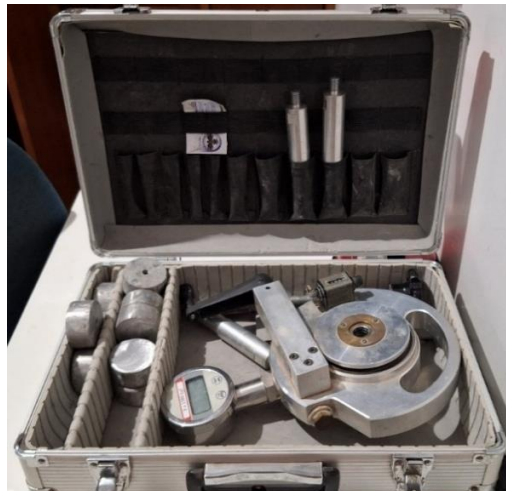
Figura 4.8 – Dinamômetro de tração usado para o ensaio de resistência de aderência à tração.
