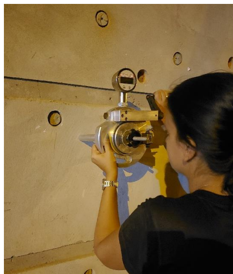
Figura 4.12 – Dinamômetro sendo utilizado no ensaio de resistência de aderência à tração.
