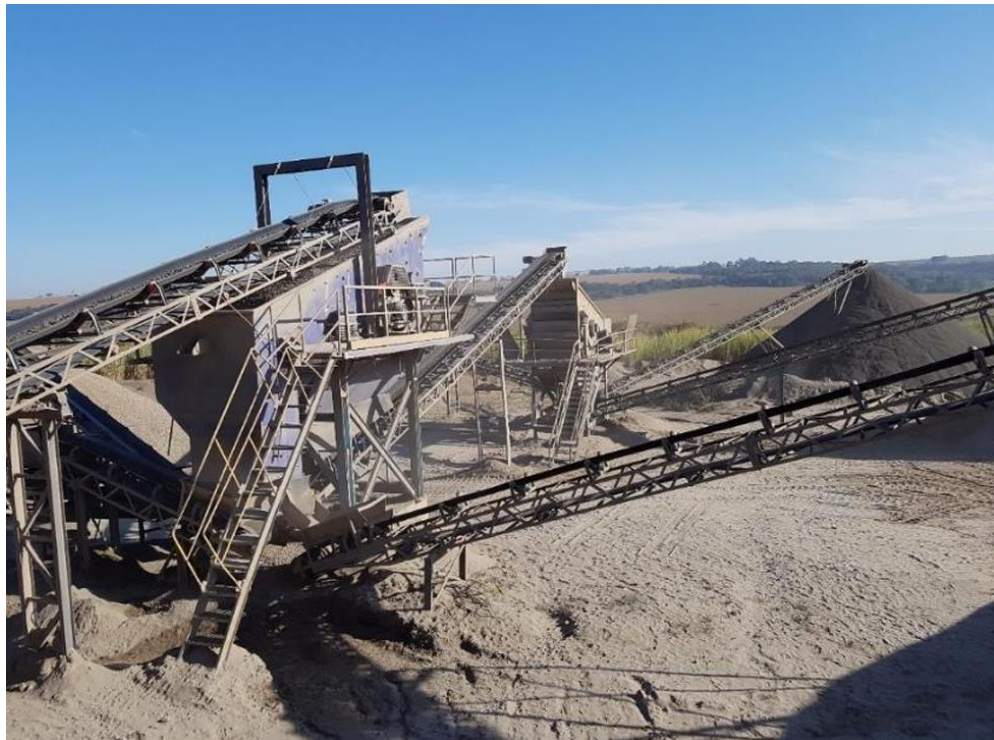
Figura 1.1 – Processo de britagem das rochas e separação dos agregados por diâmetro.
