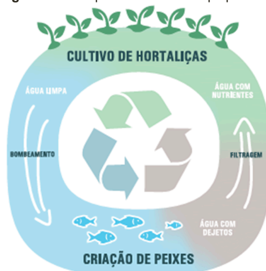
Figura 1.1 - Esquema do cultivo aquapônico
