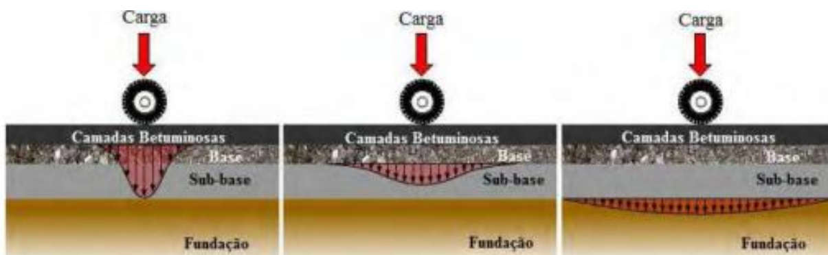
Figura 4 - Tensões induzidas em um pavimento devido às cargas móveis
