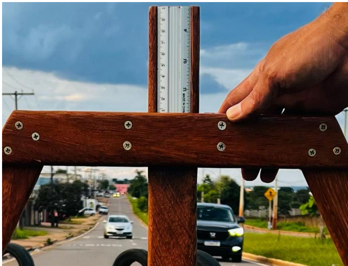
Figura 17 – Leitura do deslocamento da régua
