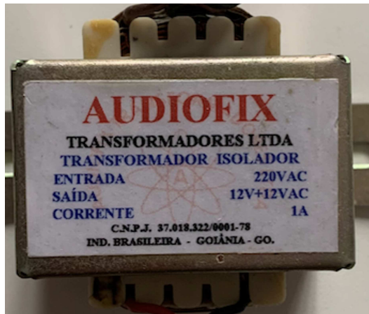
Figura 4.21 – Transformador utilizado nos testes.
