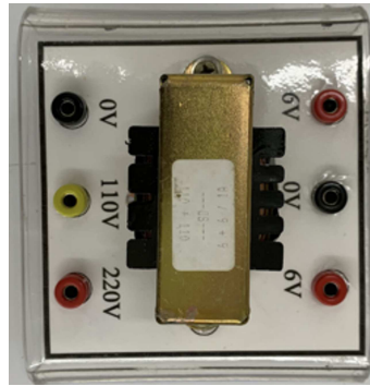
Figura 4.4 – Transformador utilizado nos experimentos.
