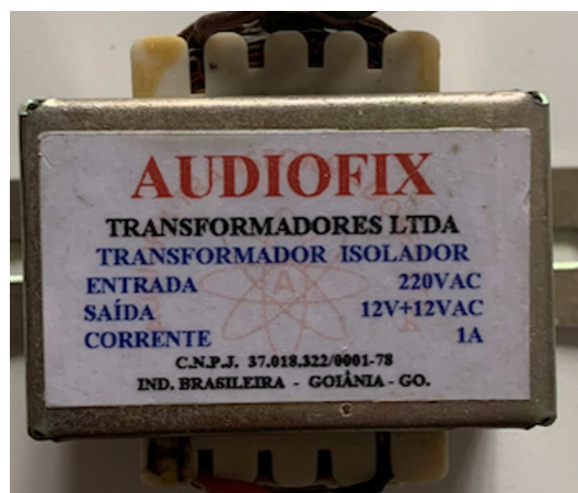
Figura 4.17 – Transformador utilizado nos experimentos.
