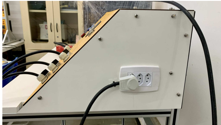
Figura 3.14 – Sistema de alimentação auxiliar.
