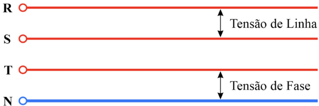
Figura 2.4 – Representação das tensões em um sistema trifásico.
