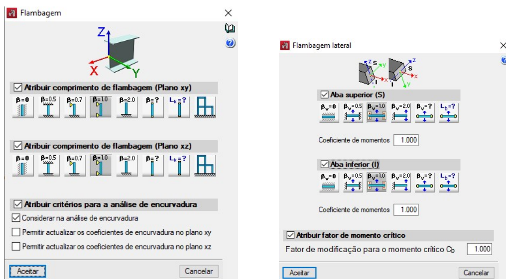
Figura 5.5: Parâmetros de flambagem para as vigas.
