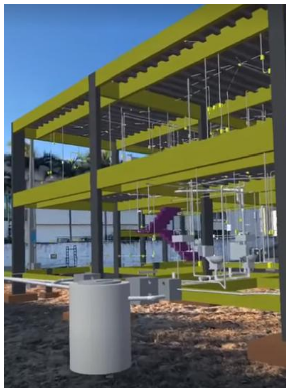
Figura 3.5 – AUGIN utilizado para locação de estrutura no terreno
