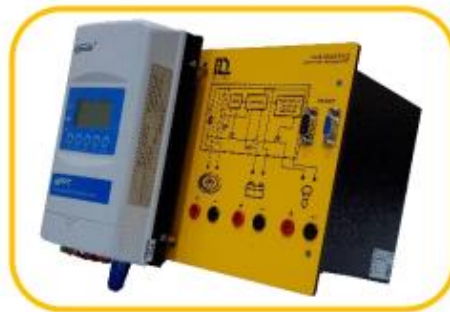
Fig.21 - Controlador de Carga Hídrica – MPPT
