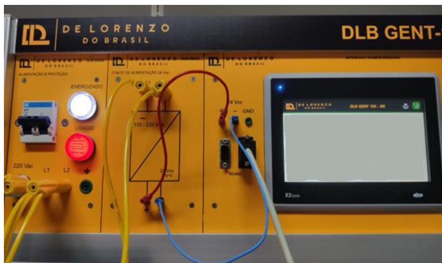
Fig.28 – Conexão entre os módulos de alimentação, fonte 24Vcc e IHM.
