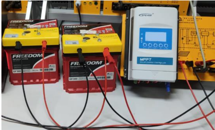
Fig.29 – Baterias 12Vcc ligadas em paralelo que foram conectadas ao controlador de carga.
