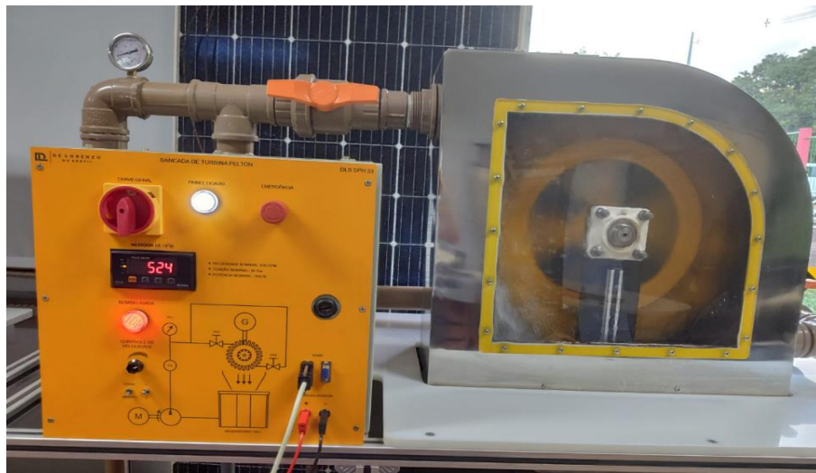
Fig.30 – Turbina didática Pelton conectada ao controlador de carga.
