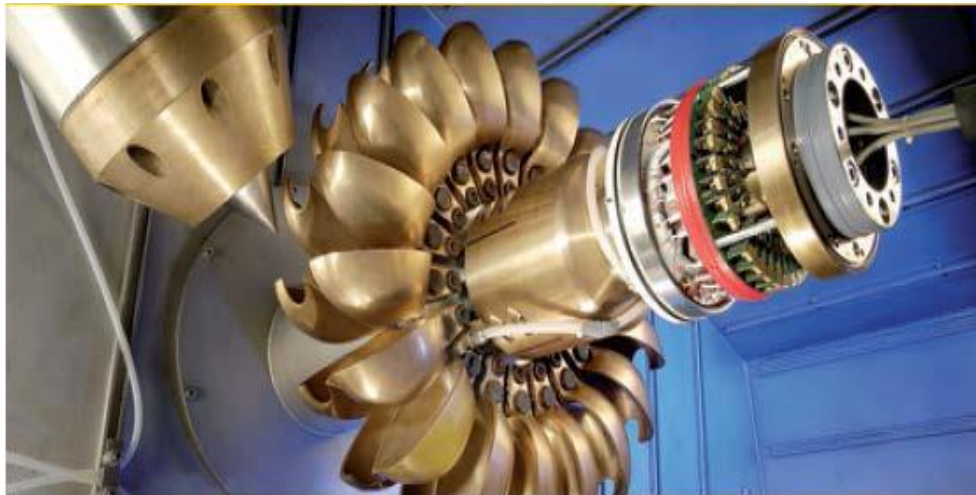
Fig. 5: Rotor Pelton com bocal injetor.
