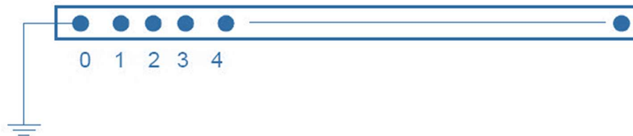
Figura 26 – Exemplo, barramento trifásico aterrado, neutro disponível.
