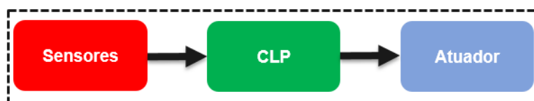
Figura 3 - Fluxo Básico de Sistema de Controle.
