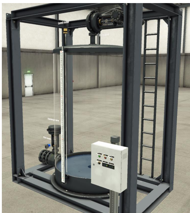
Figura 27 - Controle de Nível no Factory IO.
