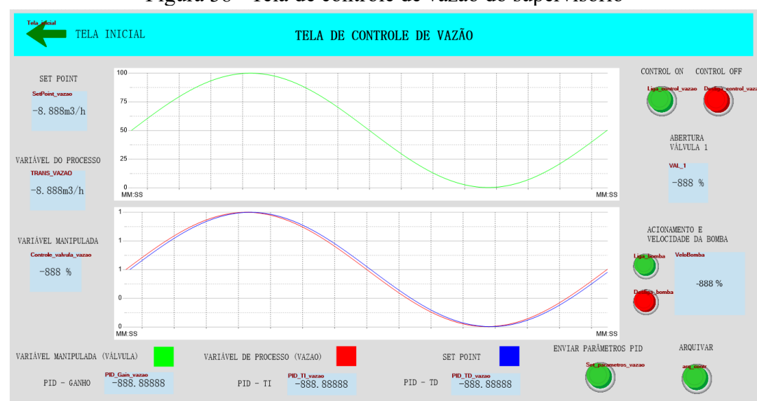
Figura 38 - Tela de controle de vazão do supervisório
