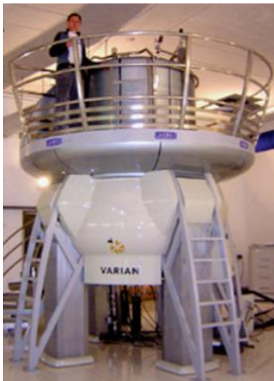
Figura 10 - Aparelho de ressonância magnética nuclear-RMN de 900 MHz com um magneto de 21.2 T no Henry Wellcome Building for NMR (HWB-NMR), Birmingham, GB
