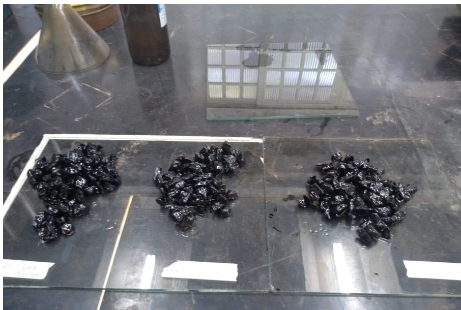
Figura 5.5 - Ensaio de adesividade com adição de DOPE com 0,8%, 0,9% e 1,0% respectivamente.
