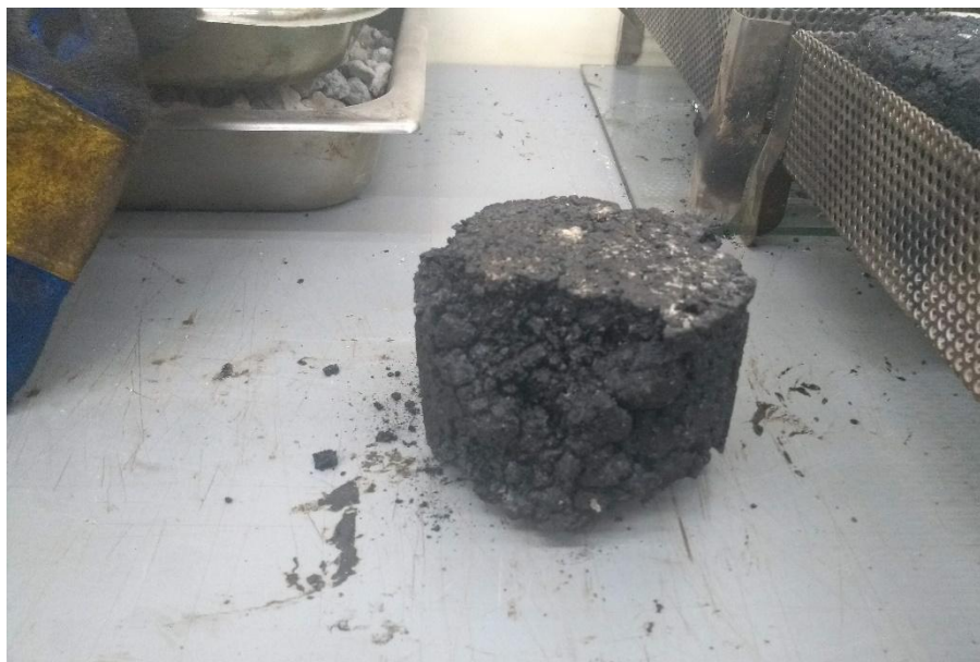
Figura 5.17 - Corpo-de-prova após 20 minutos de queima
