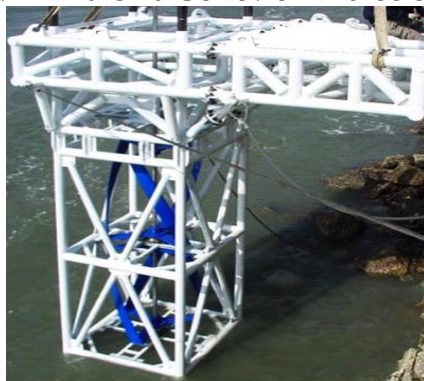
Figura 1.14 - Turbina Gorlov em hidroeletricidade.
