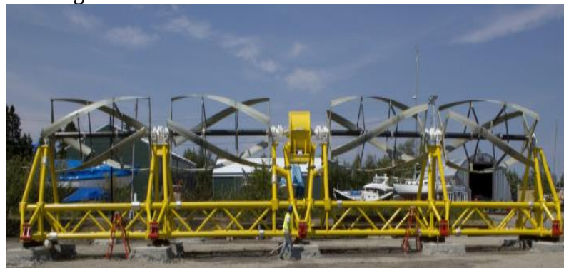
Figura 1.13 - Turbina Gorlov em hidroeletricidade.
