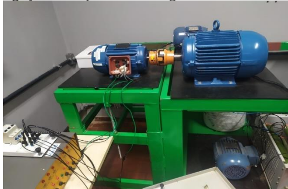
Figura 5.2 - Ligação e acoplamento do gerador de 3cv ao motor de 10cv
