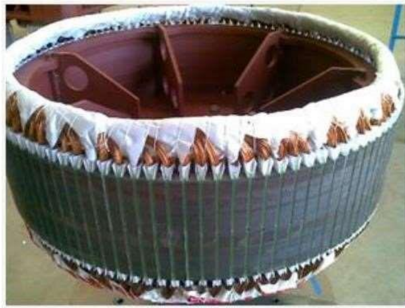
Figura 9– Estator de um gerador síncrono (NIEDERLE, 2018).
