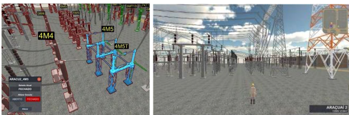
Figura 4: Sistema de controle e monitoramento em Realidade Virtual.
