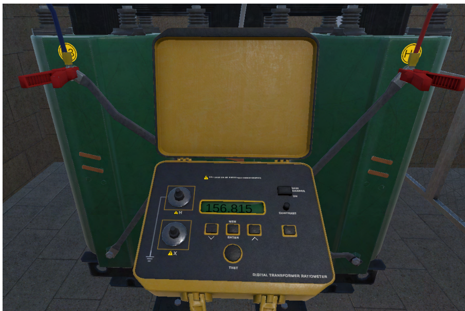
Figura 54: Visor do (a) TTR, (b) microhmímetro e (c) megômetro durante o ensaio no transformador de força
