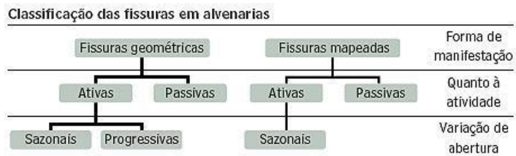
Figura 16 - Classificação das fissuras em alvenarias
