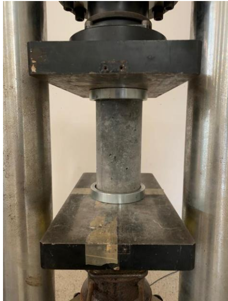
Figura 10 - Ensaio de compressão: posicionamento do corpo de prova
