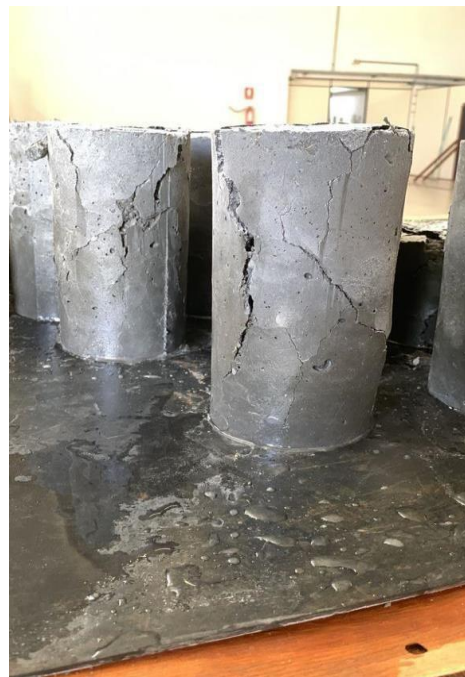
Figura 7- Corpos de desintegrados
