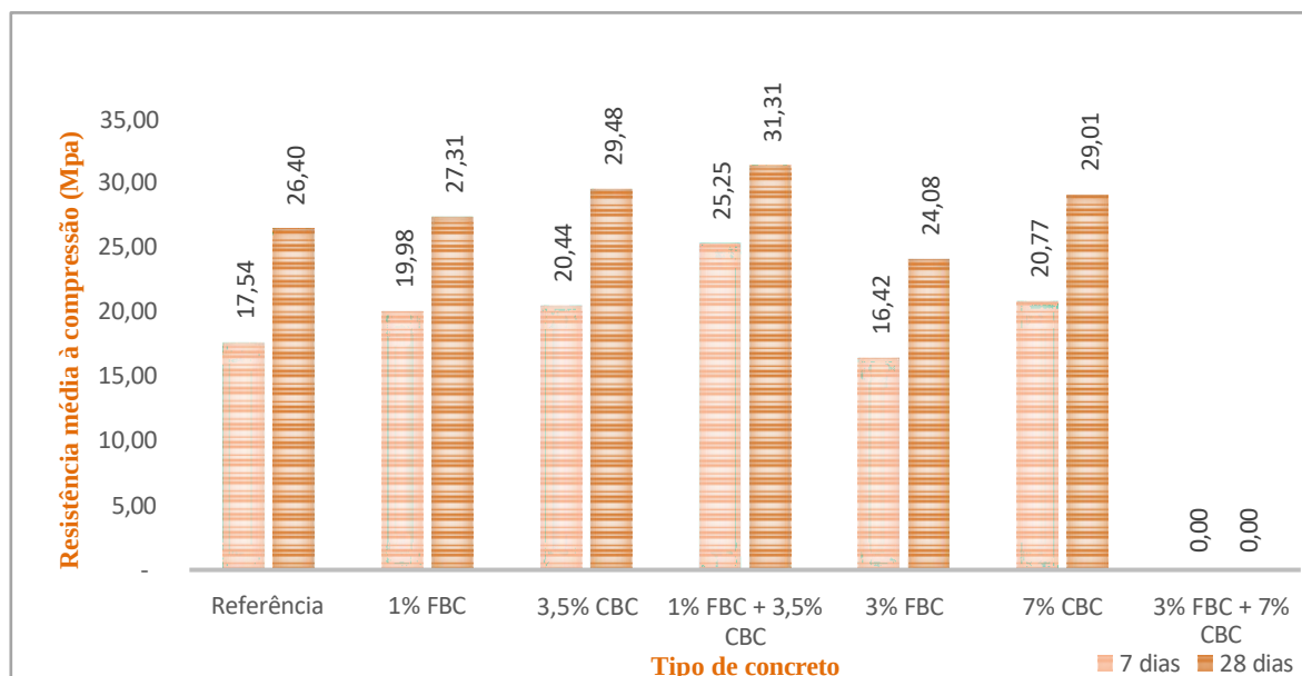
Figura 15 - Gráfico da resistência média global à compressão
