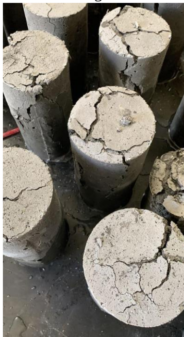
Figura 5 - Corpos de desintegrados
