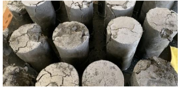
Figura 6 - Corpos de prova desintegrados
