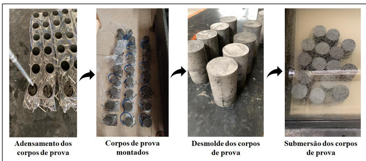
Figura 3 - Realização do processo de moldagem e cura dos corpos de prova
