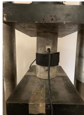
Figura 13 - Ensaio de módulo de elasticidade: execução do ensaio
