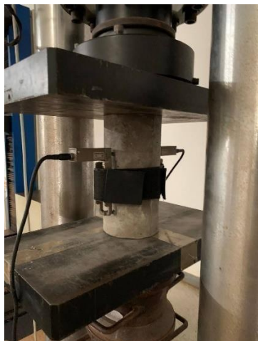
Figura 12 - Ensaio de módulo de elasticidade: posicionamento do corpo de prova
