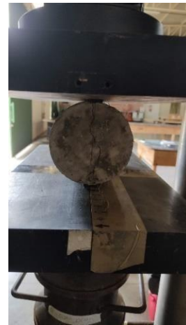
Figura 9 - Ensaio de resist. à tração por compressão diametral: Corpo de prova rompido
