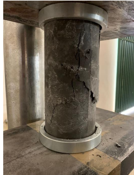
Figura 11 - Ensaio de compressão: corpo de prova rompido
