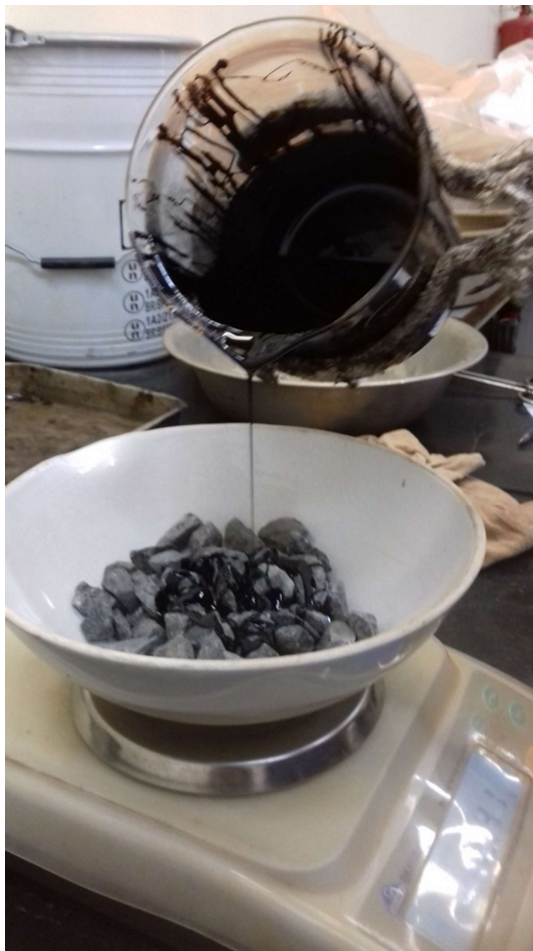
Figura 18 - Mistura do ligante asfáltico ao agregado
