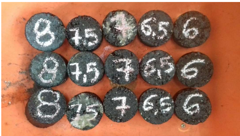
Figura 26 - Corpos de prova em repouso após compactação
