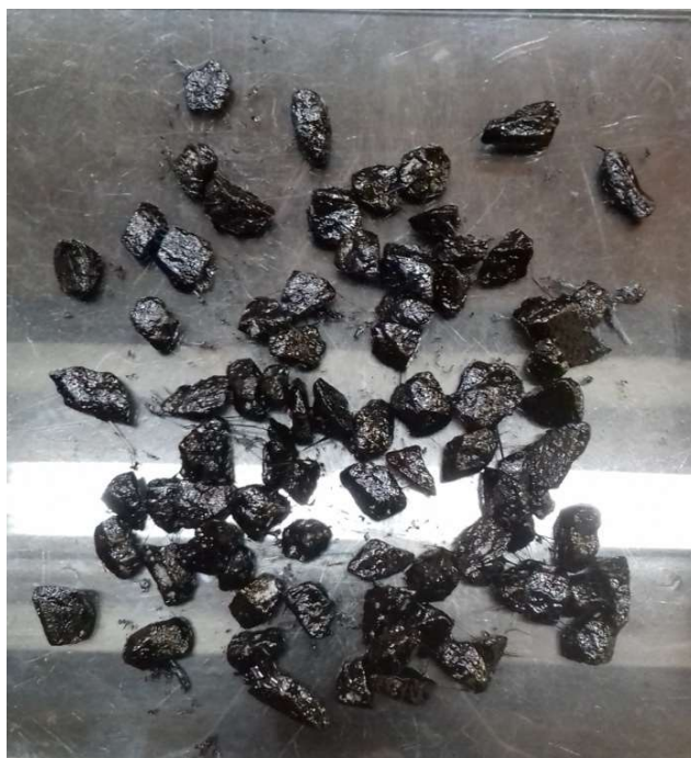
Figura 19 - Repouso dos agregados com ligante asfáltico
