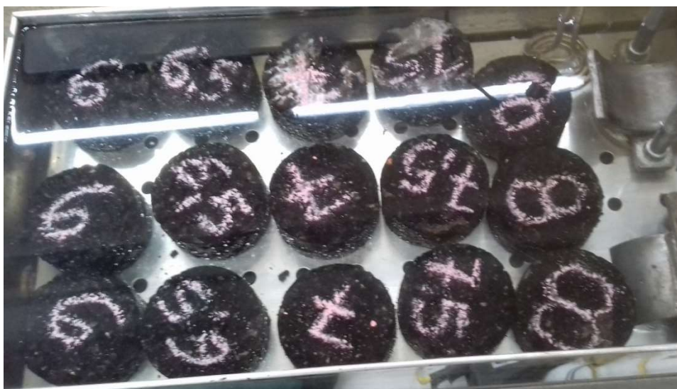
Figura 27 - Corpos de prova em banho maria na água por 30 min à 60°C
