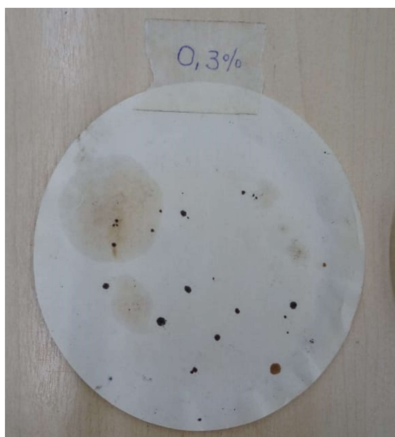
Figura 34 - Escoamento com 0,3% de bagaço de cana-de-açúcar
