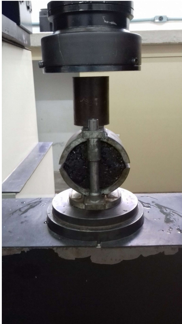
Figura 28 - Corpo de prova no molde de compressão antes de romper
