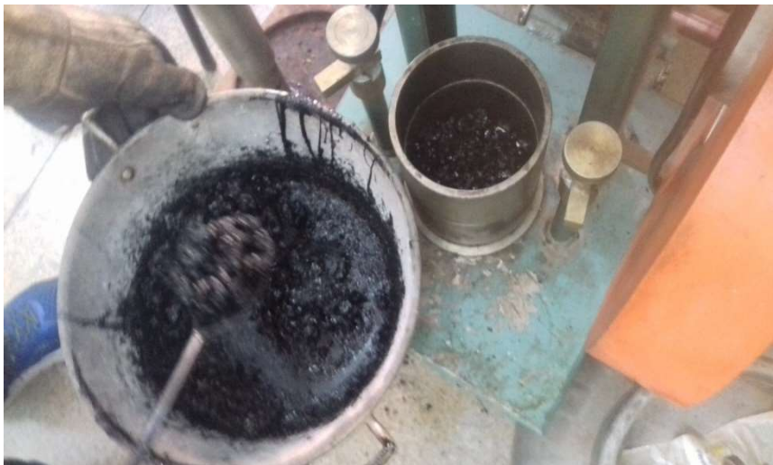
Figura 25 - Mistura sendo acomodada no cilindro de compactação
