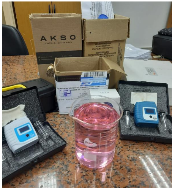
Figura 3 - Análises de cor aparente com color tester (esquerda) e análises de cloro com cloro tester (direita)
