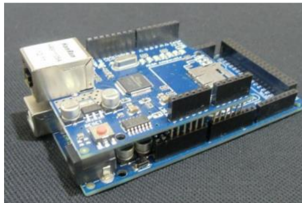
Figura 6. Ethernet Shield W5100 conectado em um Arduino MEGA 2560.
