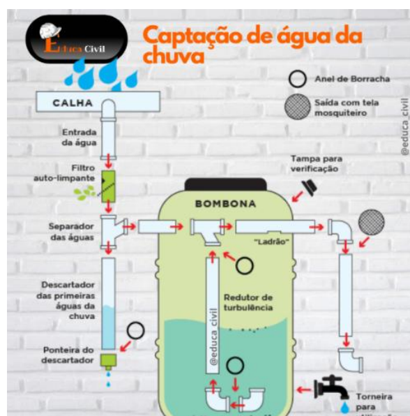
Figura 27 - Esquema de funcionamento mini cisterna
