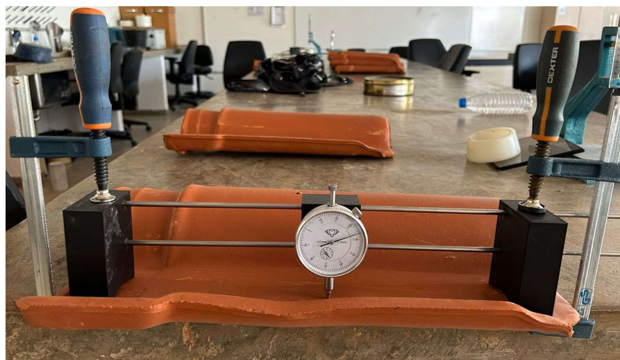
Figura 33 – Determinação da retilidade no canal da telha americana
