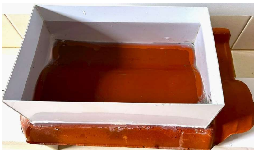
Figura 35 – Ensaio para a verificação da impermeabilidade de um dos corpos de prova
