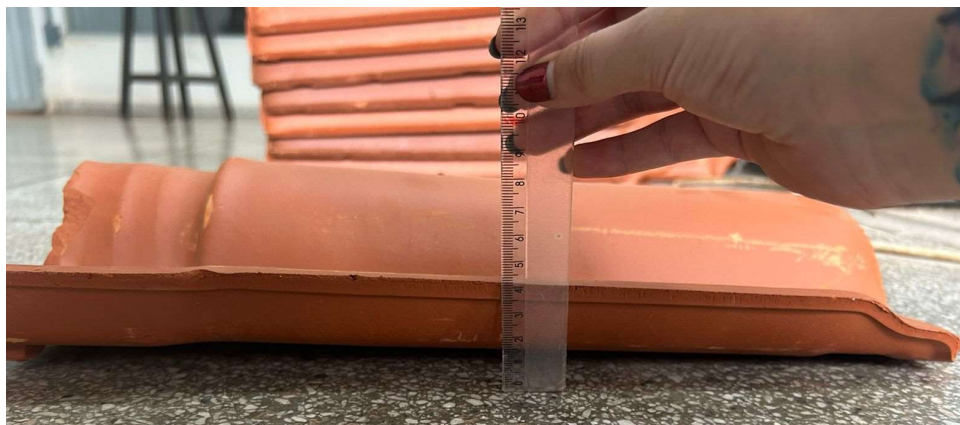
Figura 32 – Execução do ensaio de planaridade no canal da telha
