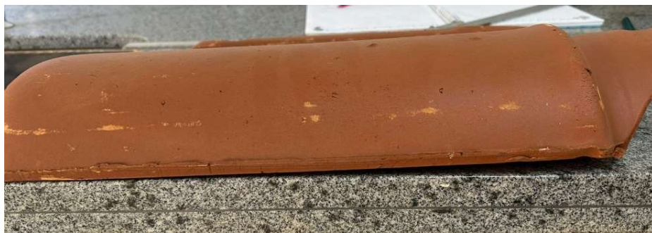
Figura 30 – Exemplo de planaridade de um corpo de prova
