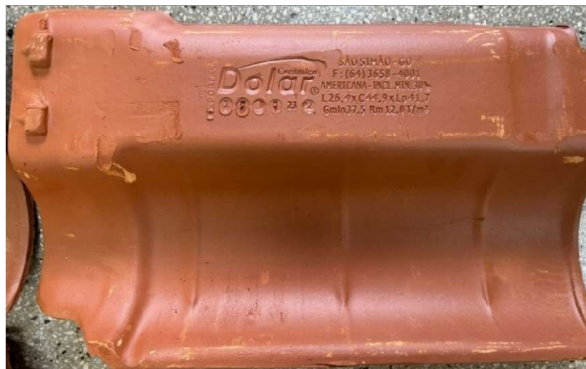
Figura 21 – Informações necessárias gravadas em reentrância.
