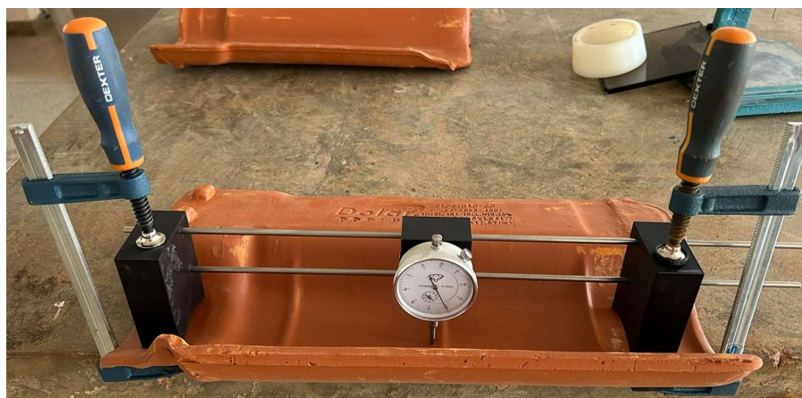
Figura 34 – Determinação da retilidade na capa da telha americana
