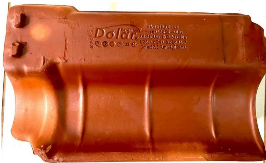
Figura 36 – Manchas de umidade em um corpo de prova
