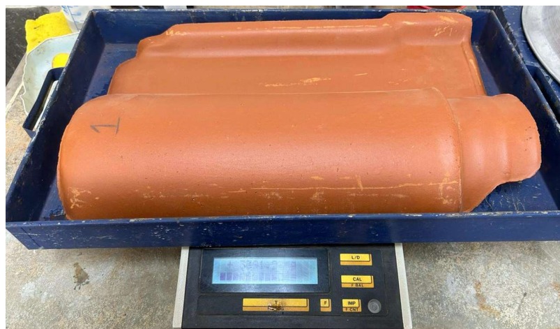
Figura 39 – Pesagem do corpo de prova após a estufa
