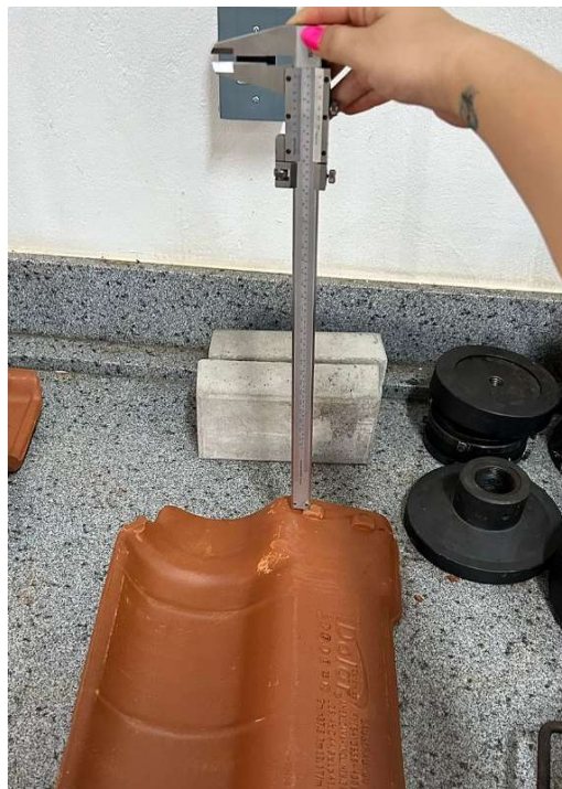
Figura 27 – Medição da altura do pino ( H_p ).
