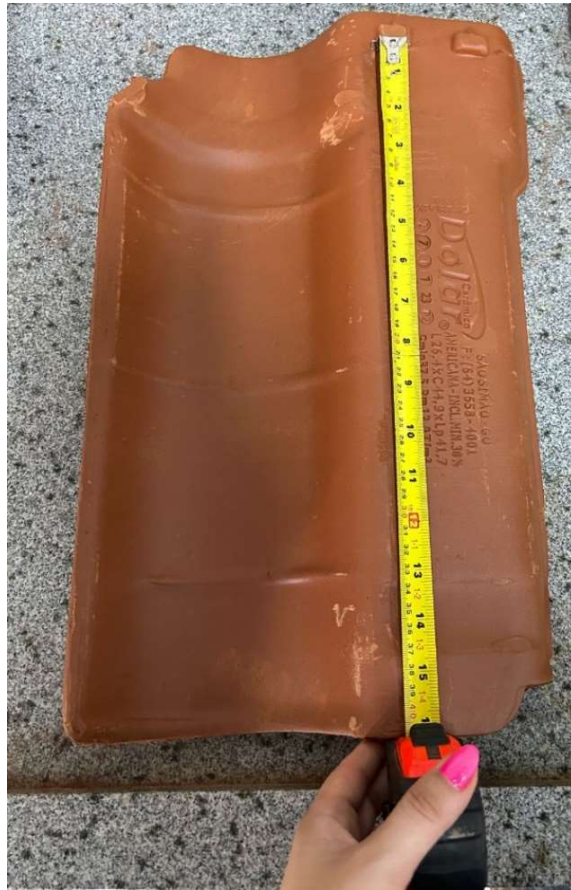
Figura 25 – Determinação da posição do pino ( L_p ).
