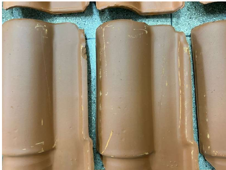
Figura 22 – Algumas escoriações, riscos e esfoliações nas amostras.
