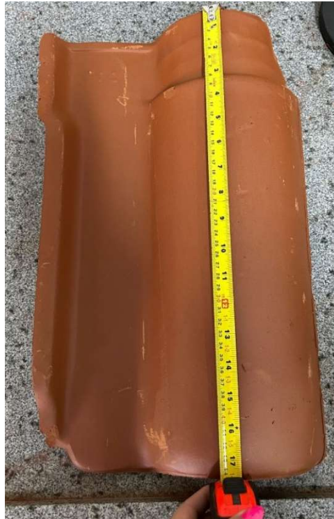
Figura 26 – Medição do comprimento efetivo (C) da telha.
