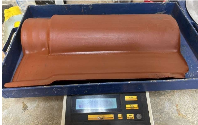
Figura 40 – Pesagem do corpo de prova após 24 horas submerso em água
