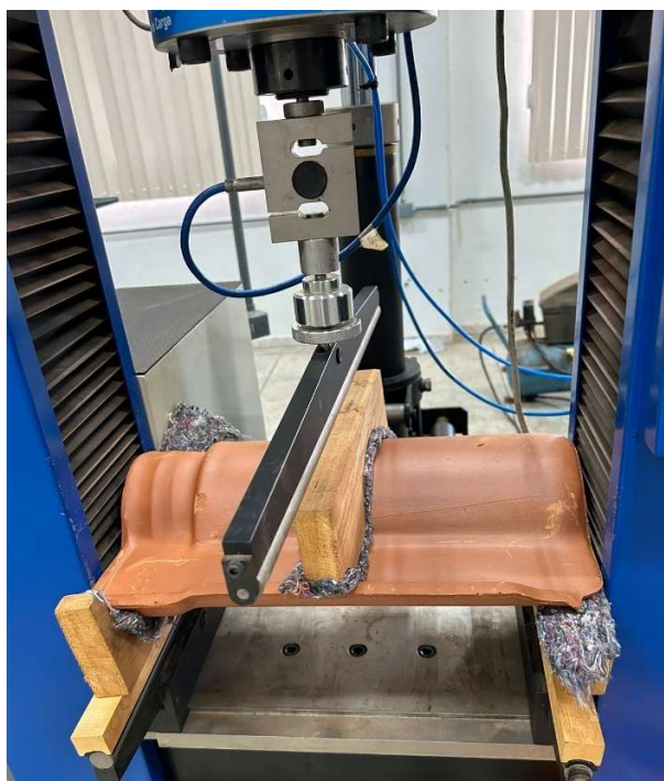
Figura 37 – Ensaio de ruptura à flexão simples com a aparelhagem necessária.
