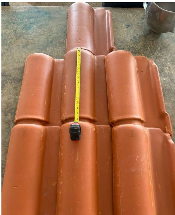
Figura 29 – Determinação do rendimento médio ( R_m ) medindo o comprimento.
