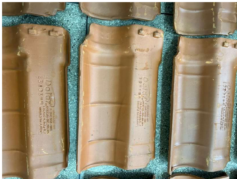
Figura 23 – Outros tipos de escoriações, riscos e esfoliações nas amostras.
