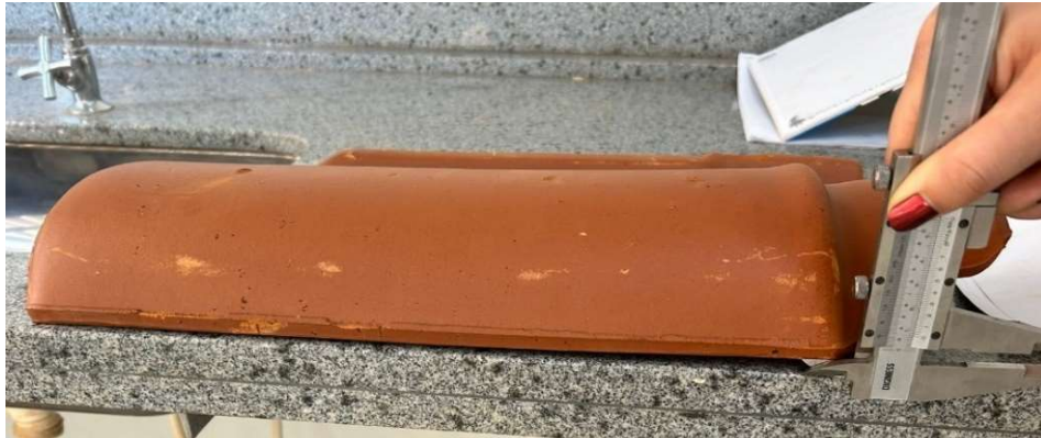
Figura 31 – Execução do ensaio de planaridade na capa da telha
