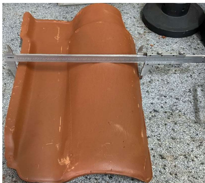
Figura 24 – Medição da largura efetiva (L) da telha.
