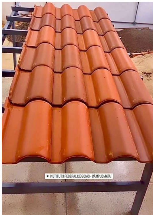
Figura 38 – Disposição dos corpos de prova sobre a estrutura metálica para a realização do ensaio
