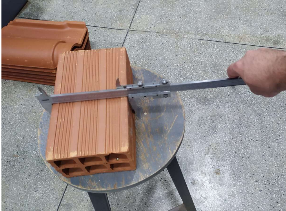
Figura 4.14: Medida das faces para verificação de conformidade
