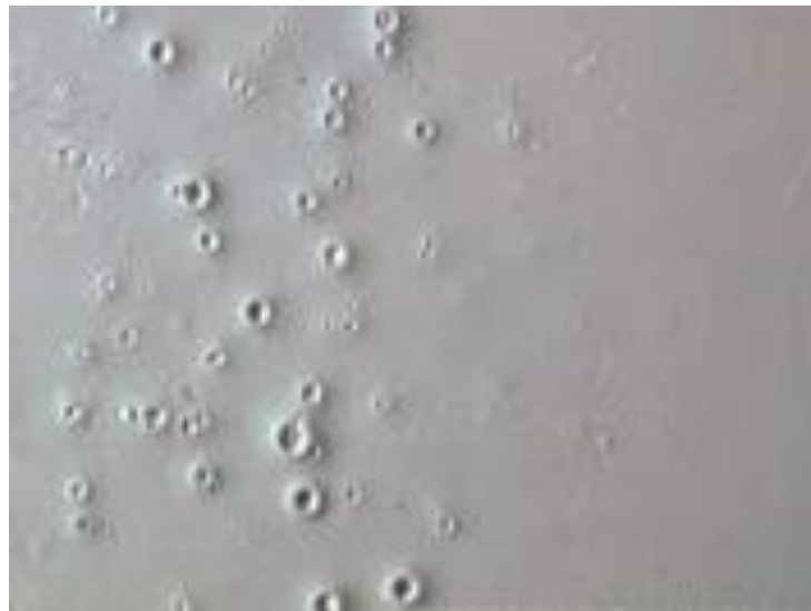
Figura 2.7 – Crateras na pintura provenientes de vesículas
