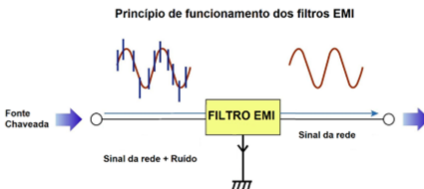
Figura 23 - Princípio de funcionamento de filtros IEM.
