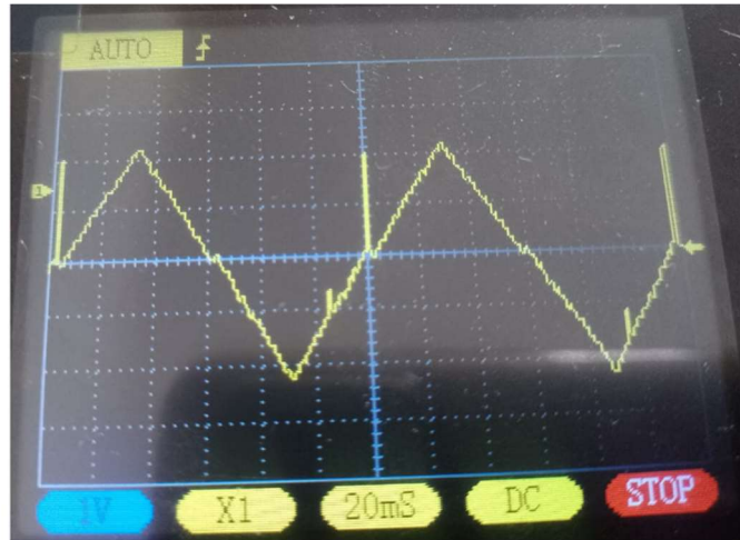
Figura 29 - Sinal triangular gerado a partir de 62 amostras.
