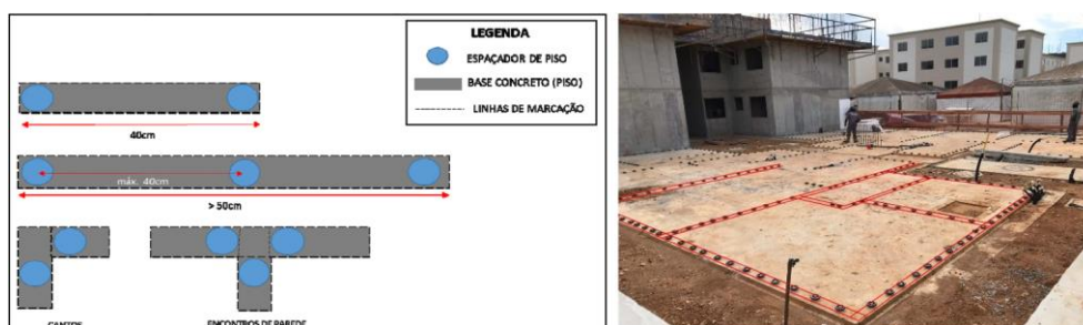
Figura 15. Distribuição espaçadores de piso.
