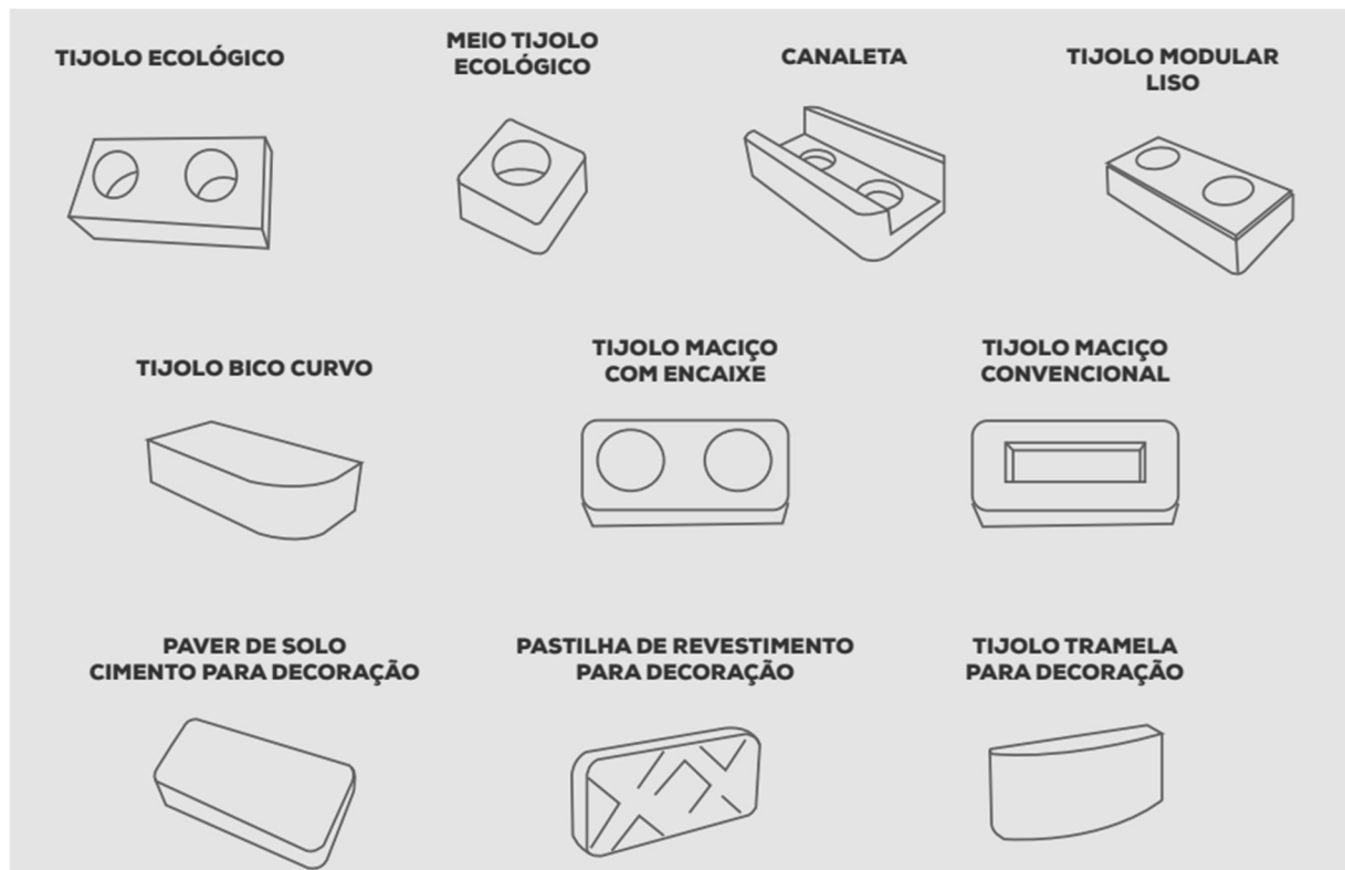
Figura 2: Modelos de Tijolo Ecológico Modular Solo-cimento
