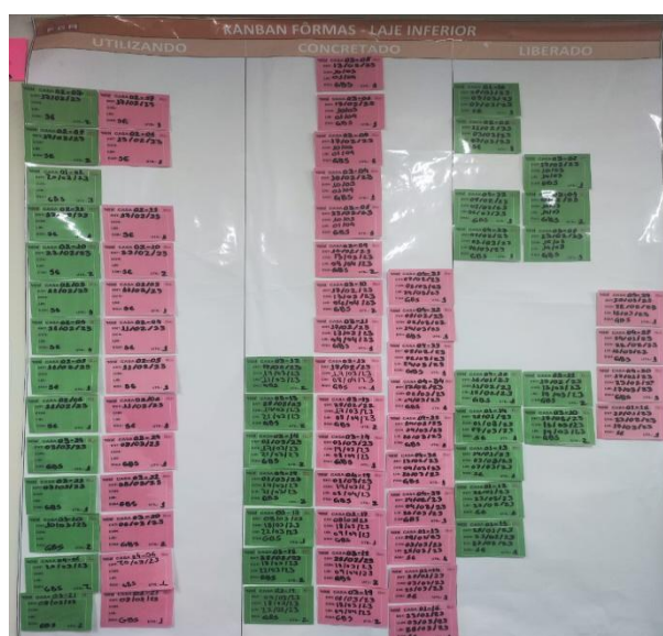
Figura 38 - Exemplo de Kanban de formas utilizado do canteiro da obra A.
