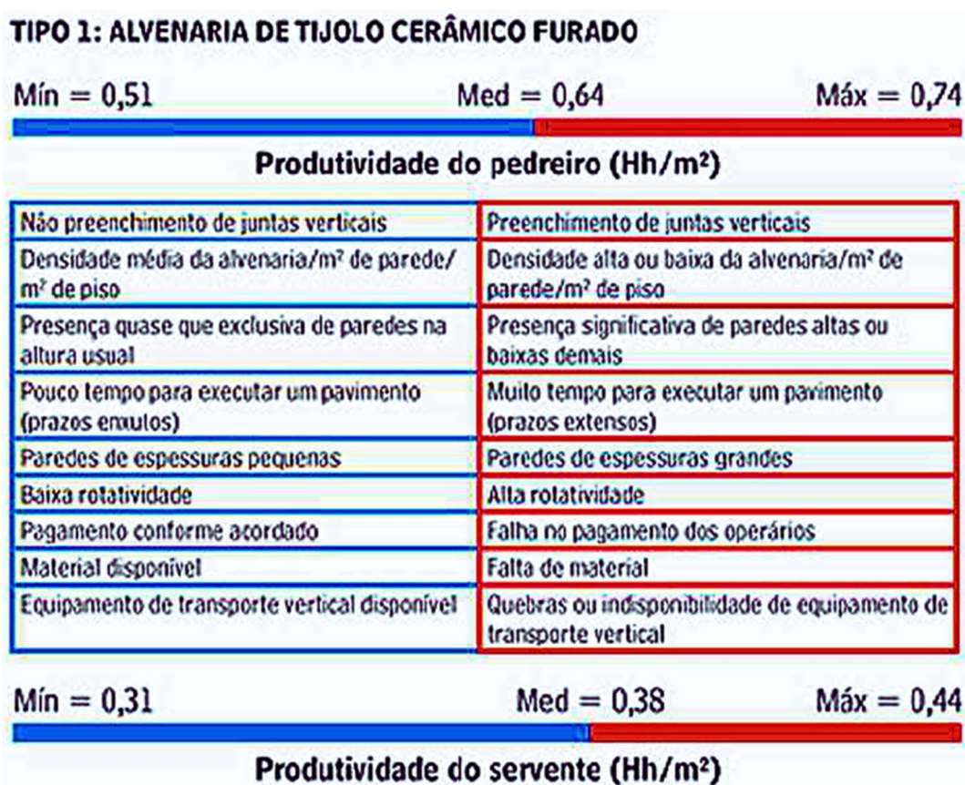
Figura 9 - Índice de produtividade da mão de obra (alvenaria de vedação)
