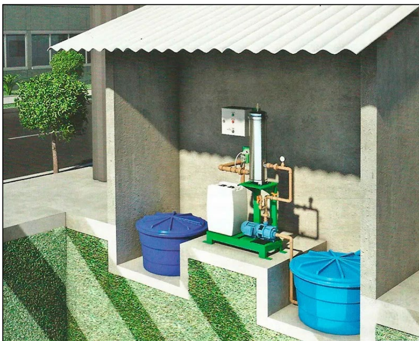
Figura 5 – Sistema de bombeamento de água da chuva
