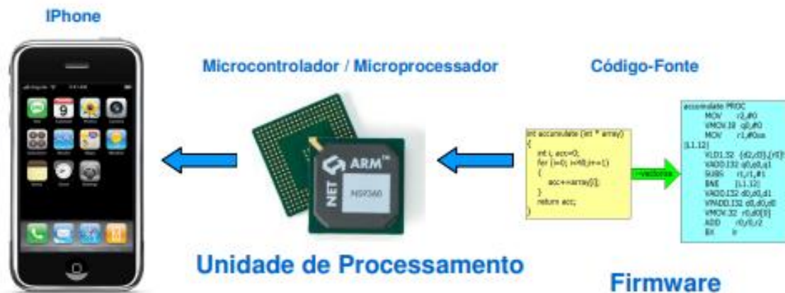
Figura 04 - Funcionamento lógico de um sistema embarcado
