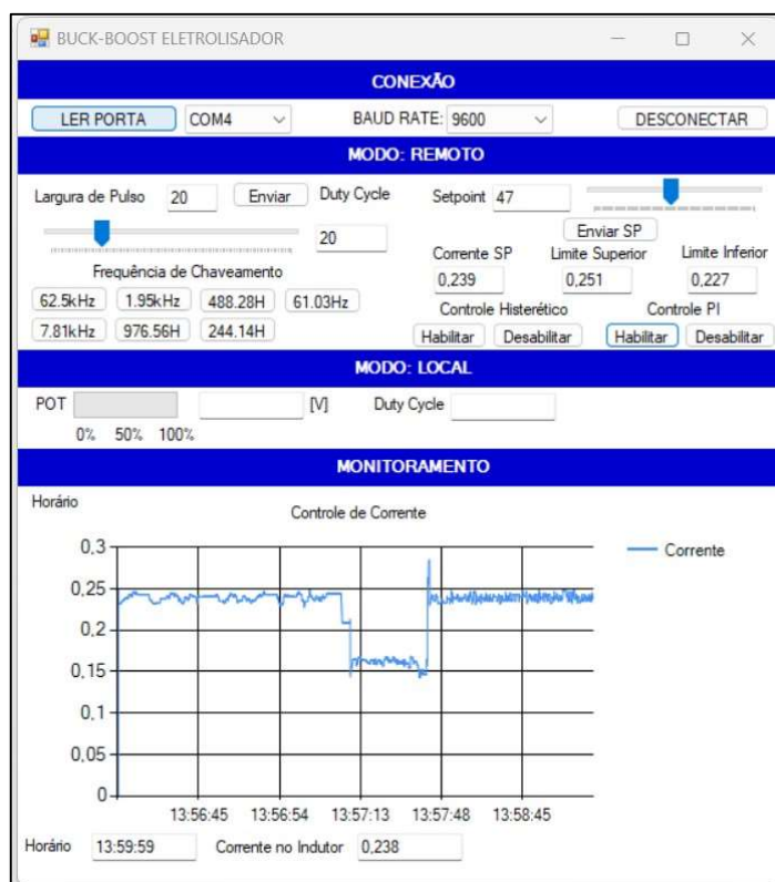
Figura 134 - Experimento 11: controle em malha fechada via técnica PI (proporcional-integral); SP = 239mA.
