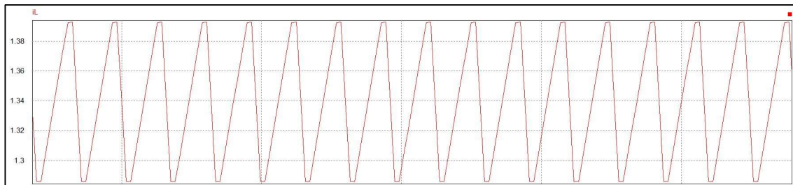
Figura 26 - Ripple Corrente no Indutor.
