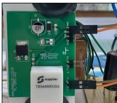
Figura 92 - Fonte chaveada isolada.
