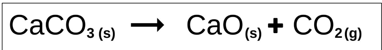
Figura 08 – Reação química de calcinação do carbonato de cálcio (CaCO 3 ).
