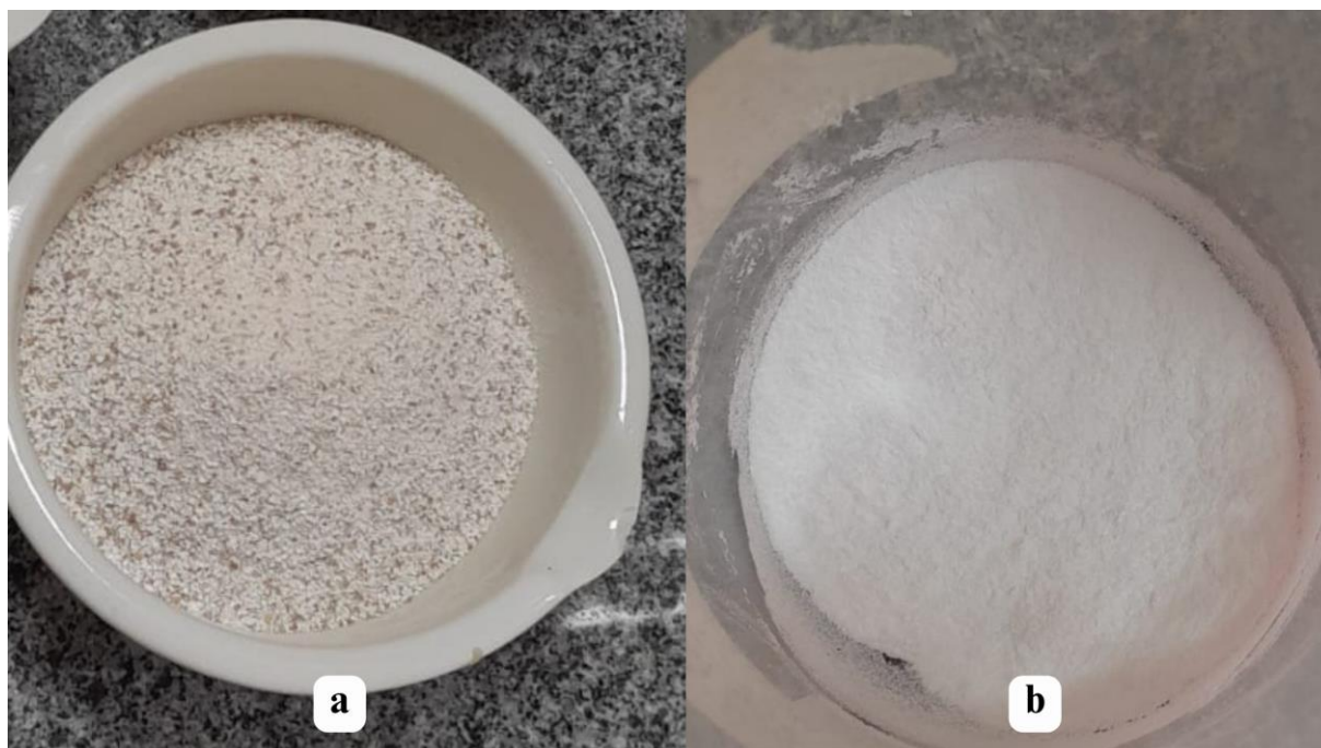
Figura 10 – Aspecto físico das cascas de ovos in natura (a) e após a calcinação a 850 °C por 4h (b).
