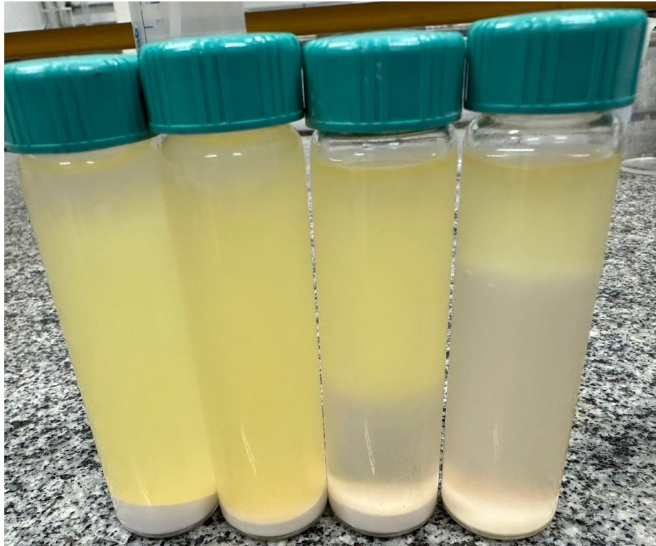
Figura 19 – Teste de produção do biodiesel, conforme parâmetros reacionais descritos na Tabela 2 para o teste 8, utilizando o sebo B, após a centrifugação.
