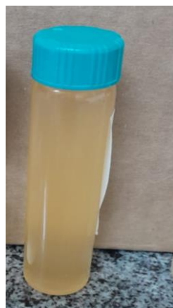
Figura 20 – Glicerina coletada após a separação do biodiesel.
