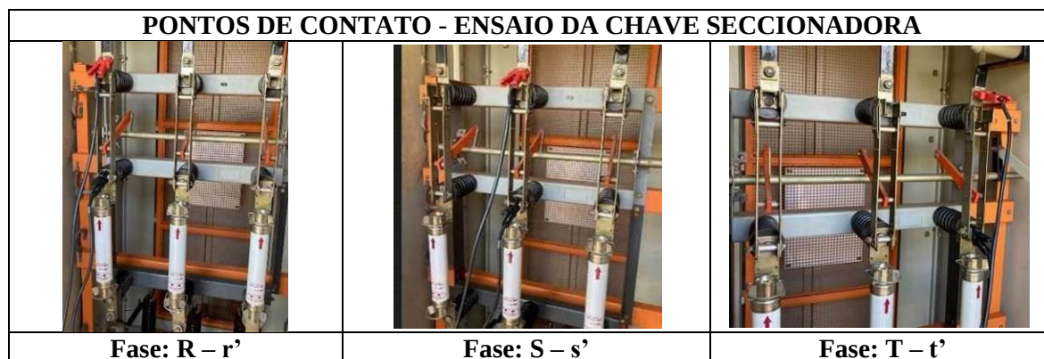
Figura 83 - Pontos de contato das garras do ensaio de resistência de contato.
