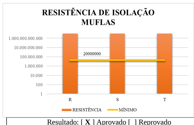
Gráfico 26 - Resistência de isolamento mufla de isolamento do estudo de prova 02.
