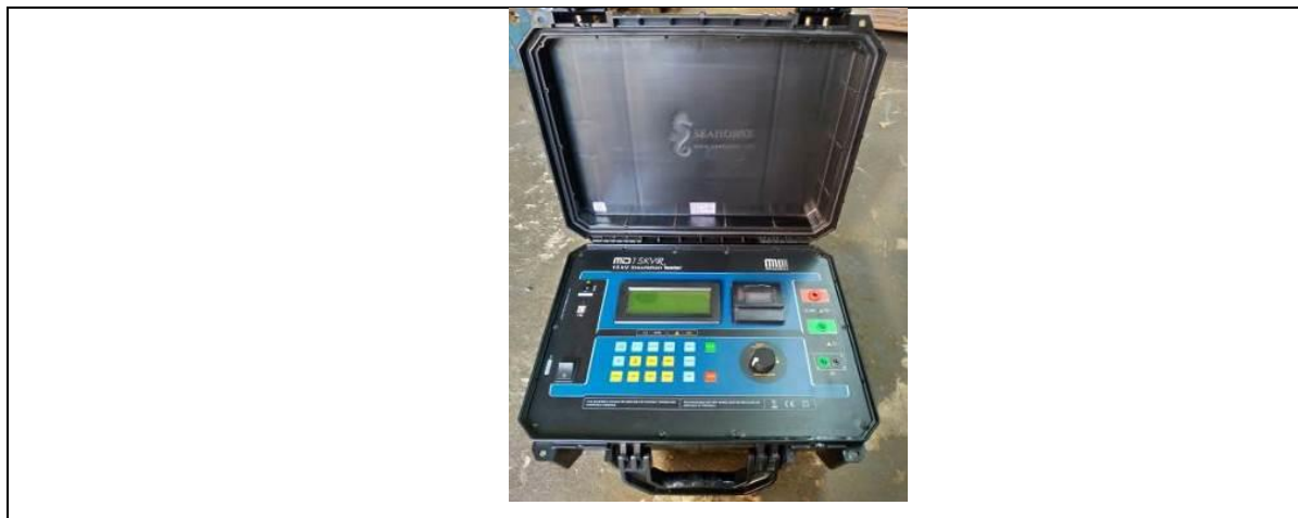
Figura 37 – Megômetro digital – Megabras, capacidade de 0,5 KV a 10KV, alcance de 10Tohms. Fonte: (Acervo do autor)
