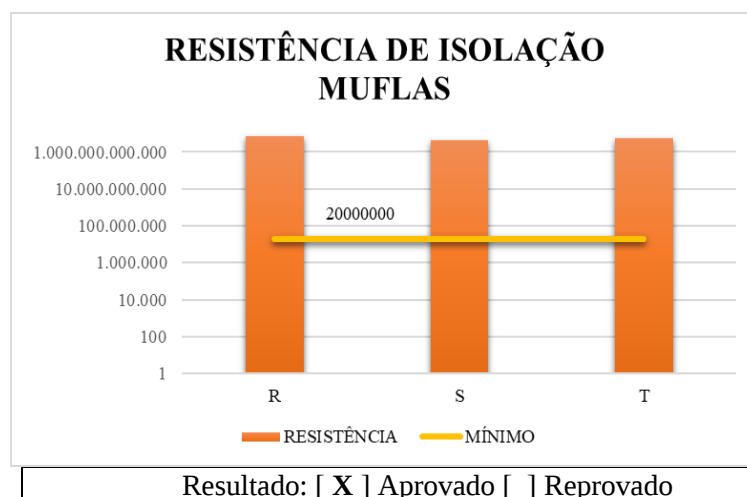
Gráfico 25 - Resistência de isolação mufla de isolação do estudo de prova 01.
