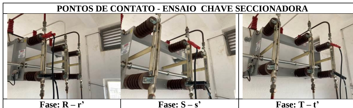
Figura 81 - Pontos de contato das garras do ensaio de resistência de contato.
