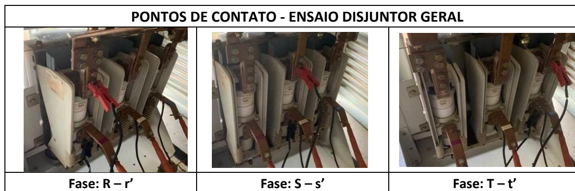
Figura 73 - Pontos de contato das garras do ensaio de resistência de contato.
