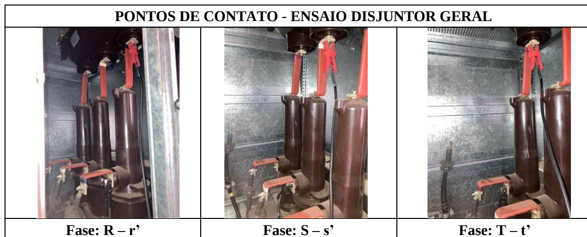
Figura 77 - Pontos de contato das garras do ensaio de resistência de contato.
