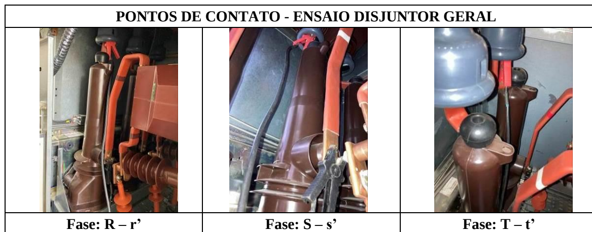
Figura 79 - Pontos de contato das garras do ensaio de resistência de contato.
