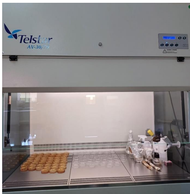
Figura 1 – Câmara de fluxo laminar, asséptica, onde foi realizada a inoculação dos grãos de amendoim amostrados em meio de cultura.
