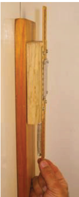
Fig. 5 – A mola é puxada até que o bloco fique na iminência do movimento.
