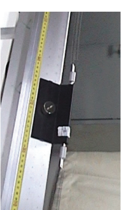
Figura 4 - Carrinho preso a duas molas para a experiência Energia. O filme correspondente ao movimento pode ser apreciado em http://fep.if.usp.br/~fistoto/energia/energia.f.htm .
