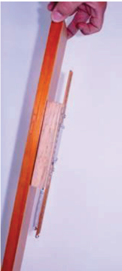
Fig. 7 – Determinação do coeficiente de atrito estático pelo ângulo crítico.
